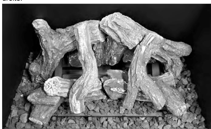
ÉTAPE 5 : Placez la braise incandescente à l'avant du tube de brûleur et des plaques de braise. Placez les roches et vermiculite sur le plateau de brûleur tel qu'illustré. NE PAS PLACER DE ROCHE NI VERMICULITE SUR LE TUBE DE BRÛLEUR
